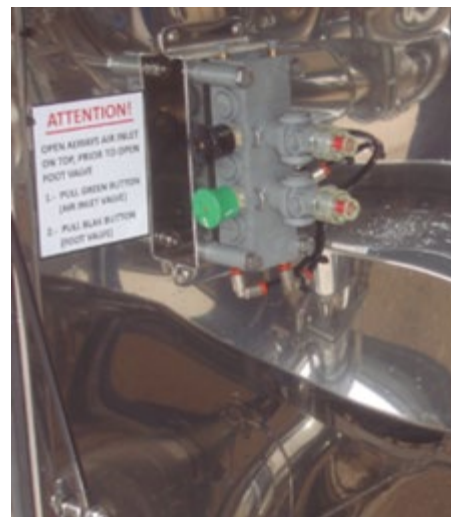
FIGURE 32: Commandes pneumatiques système séquentiel
