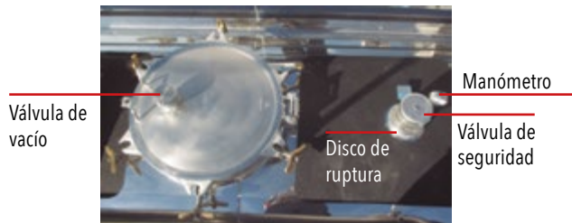
FIGURA 37: Válvula vacío + válvula seguridad + disco de ruptura
