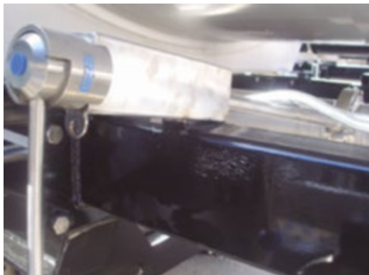
FIGURE 28: Vannes manuelles en inox avec rallonge de poignée
