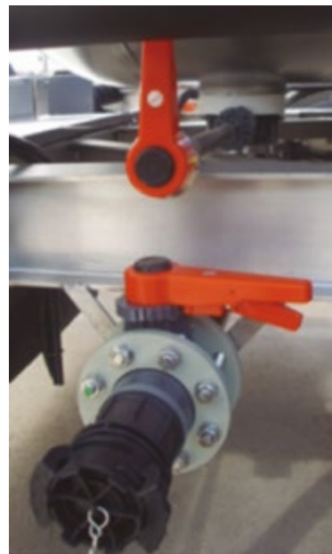
FIGURE 29: Vannes manuelles pour citerne ADR ebonitas
