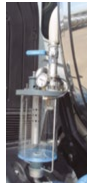
FIGURA 36: Vaso de vacío colocado en una cisterna fija sobre camión
