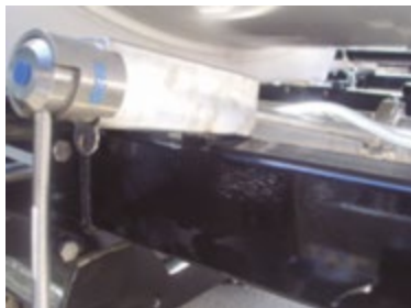
FIGURA 28: Válvulas manuales en inoxidable con alargo de maneta
