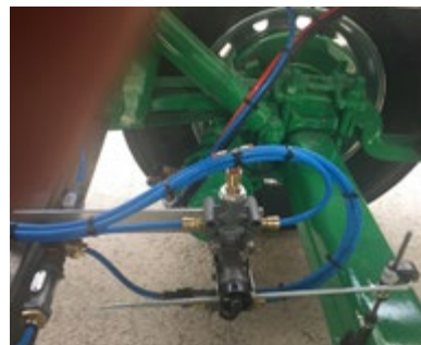
FIGURA 4: Válvula de nivelación con corte
