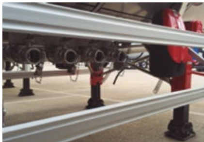
FIGURA 30: Colector individual con válvulas laterales manuales
