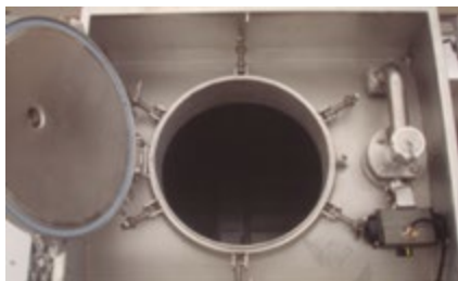
FIGURE 33: Collecteur de pression équipé d'une vanne pneumatique d'admission à pression au compartiment
