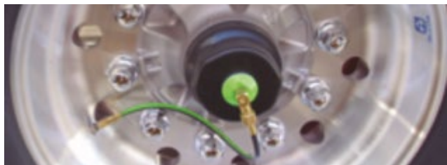
FIGURA 14: Sistema de control de presión de los neumáticos
