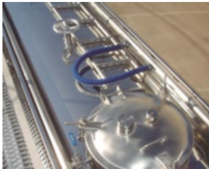
FIGURA 26: Colector de presión por latiguillos independiente de limpieza
