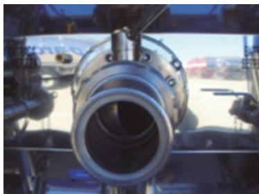
FIGURA 27: Colector longitudinal con válvula de salida manual
