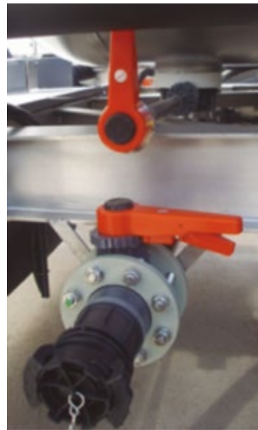
FIGURA 29: Válvulas manuales para cisterna ADR ebonitas
