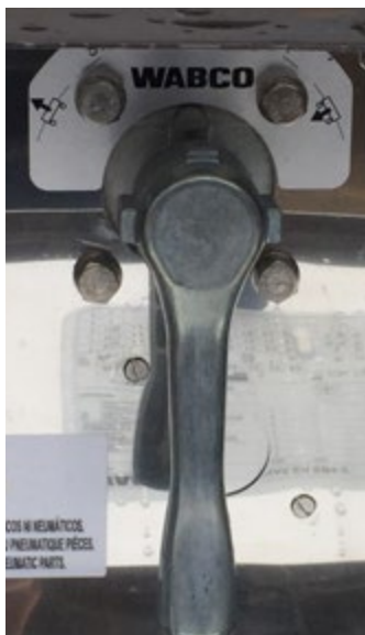
FIGURA 7: Válvula reguladora de altura de la suspensión
