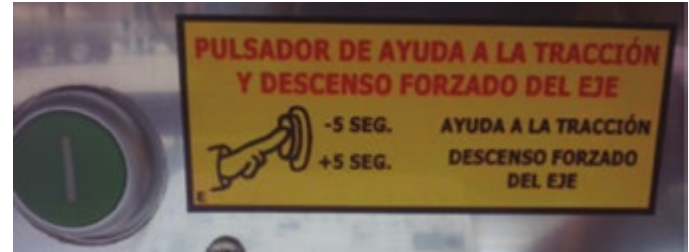
FIGURE 6: Bouton d'aide à la traction et descente forcée de l'essieu
