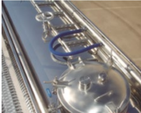
FIGURE 26: Collecteur de pression indépendant pour flexibles de nettoyage
