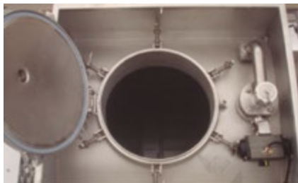
FIGURA 33: Colector de presión dotado de una válvula neumática de entrada a presión al compartimento
