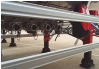
FIGURE 30: Collecteur individuel avec vannes latérales manuelles
