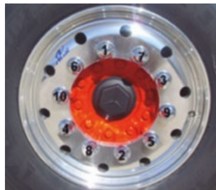
FIGURE 11: Serrage en étoile des boulons
