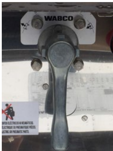
FIGURE 7: Vanne de réglage en hauteur de la suspension
