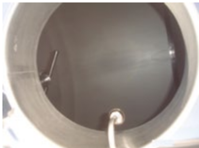
FIGURA 23: Sistema de limpieza por cuello con sensor de llenado
