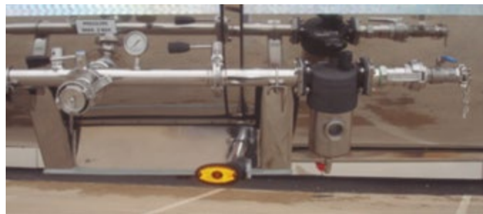
FIGURE 25: Collecteur de pression avec filtre
