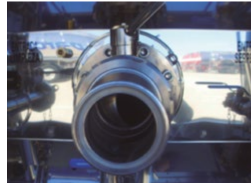
FIGURE 27: Collecteur longitudinal avec vanne d'échappement manuelle
