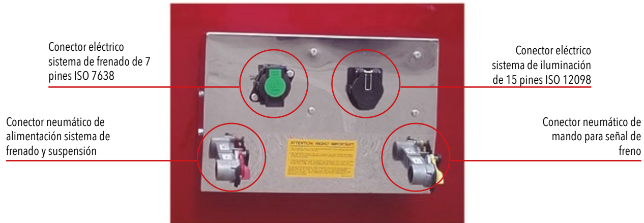
FIGURA 2: Conexiones eléctricas y neumáticas
