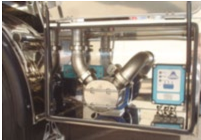
FIGURA 35: Ejemplo de bomba de tipo auto-aspirante con rodete de goma con accionamiento hidráulico y con control de llenado y vaciado
