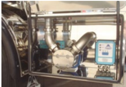
FIGURE 35: Exemple de pompe du type auto-aspirante avec roue en caoutchouc à actionnement hydraulique et avec contrôle du niveau de remplissage et de vidage
