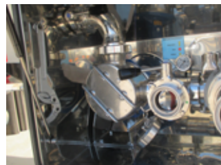
FIGURA 32: Ejemplo de bomba de tipo auto-aspirante con rodete de goma con accionamiento hidráulico y con control de llenado y vaciado
