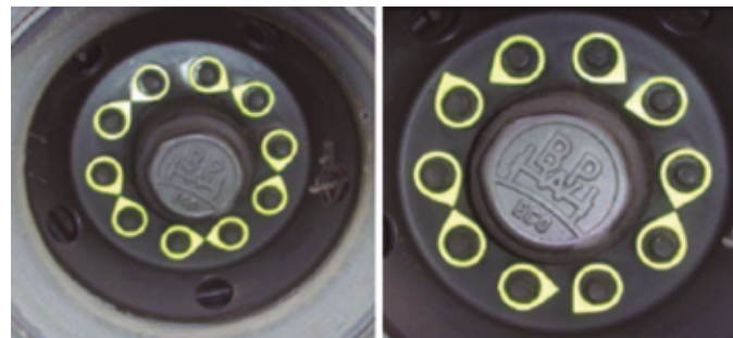
FIGURE 10: Montage initial (figure gauche) et montage à risque (figure droite)
