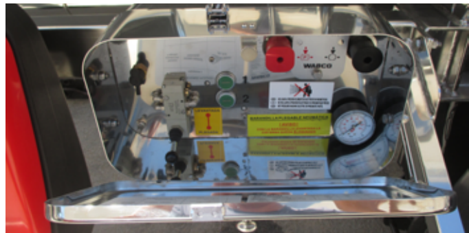
FIGURA 7: Cajón de mandos dispuesto en lateral
