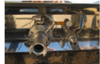
FIGURE 26: Collecteur longitudinal avec vanne d'échappement manuelle
