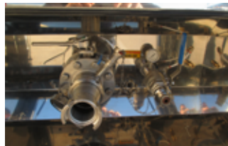
FIGURA 26: Colector longitudinal con válvula salida manual con barrido de mangueras
