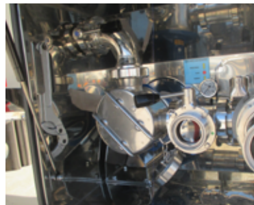
FIGURE 32: Exemple de pompe du type auto-aspirante avec roue en caoutchouc à actionnement hydraulique et avec contrôle du niveau de remplissage et de vidage
