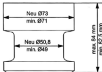
FIGURE 1:: tolérance du boulon d'accouplement de 2" et 3.5"
