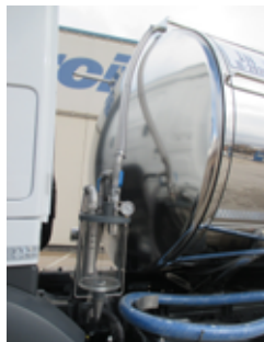
FIGURA 34: Vaso de vacío colocado en una cisterna fija sobre camión
