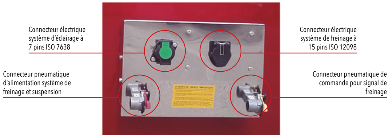
FIGURE 2: Connexions électriques et pneumatiques
