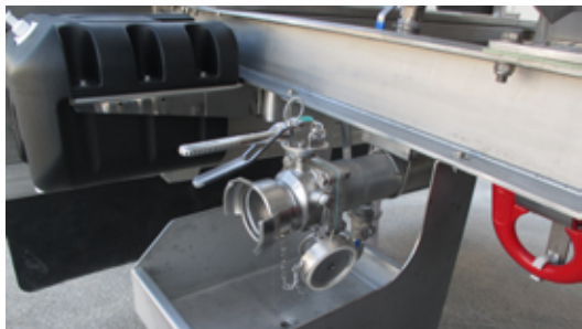
FIGURE 27: Collecteur individuel avec vannes latérales manuelles
