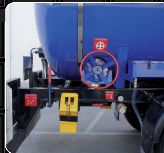
Cisterna autoportante fabricada en acero al carbono. Self-supporting tanker made of carbon steel. SR Citerne autoportante avec cuve en acier noir.
