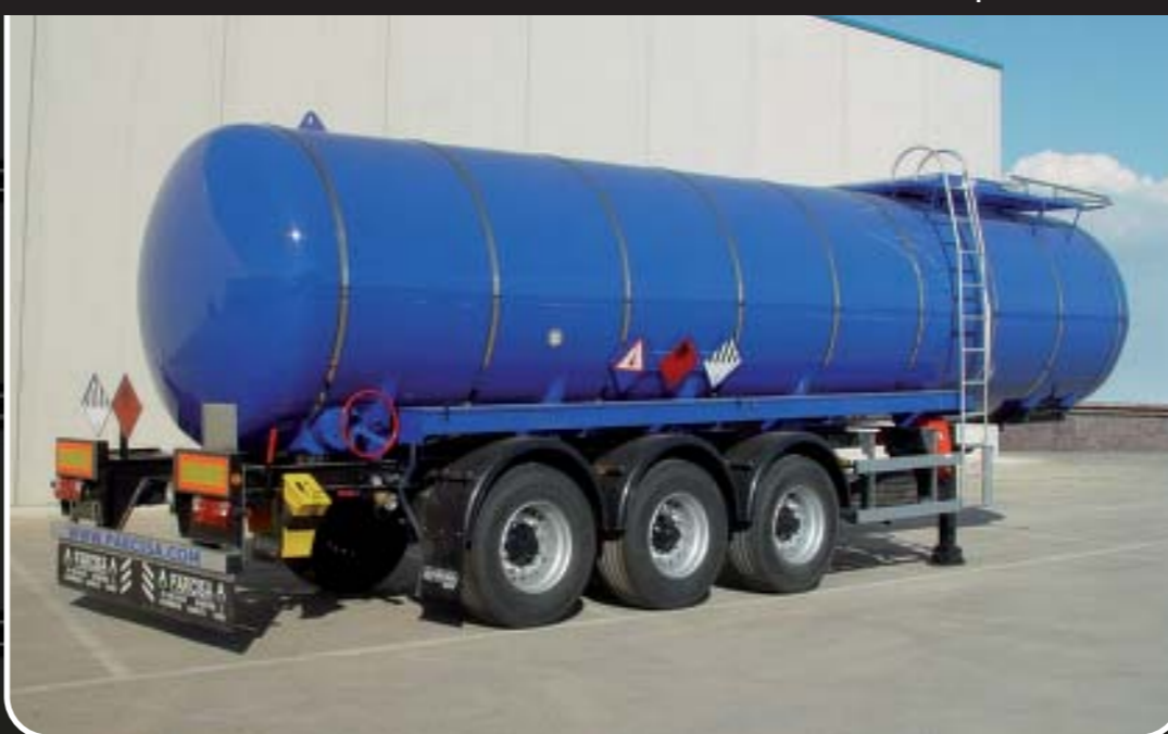
Cisterna autoportante fabricada en acero al carbono. Self-supporting tanker made of carbon steel. SR Citerne autoportante avec cuve en acier noir.
