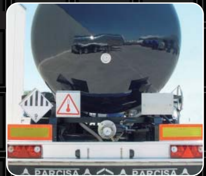
Cisterna autoportante fabricada en acero inoxidable. Self-supporting tanker made of stainless steel. SR Citerne autoportante avec cuve fabriqué en inox.
