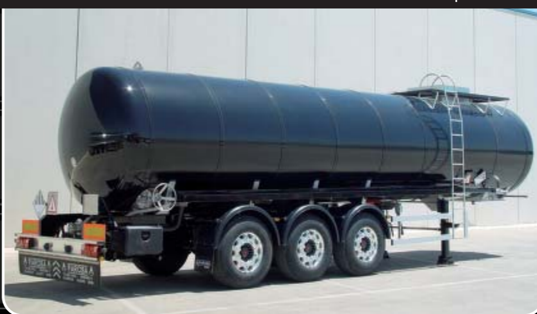
Cisterna autoportante fabricada en acero inoxidable. Self-supporting tanker made of stainless steel. SR Citerne autoportante avec cuve fabriqué en inox.
